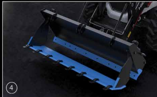
Godet avant du chargeur plus durable, renforcé avec du hardox
