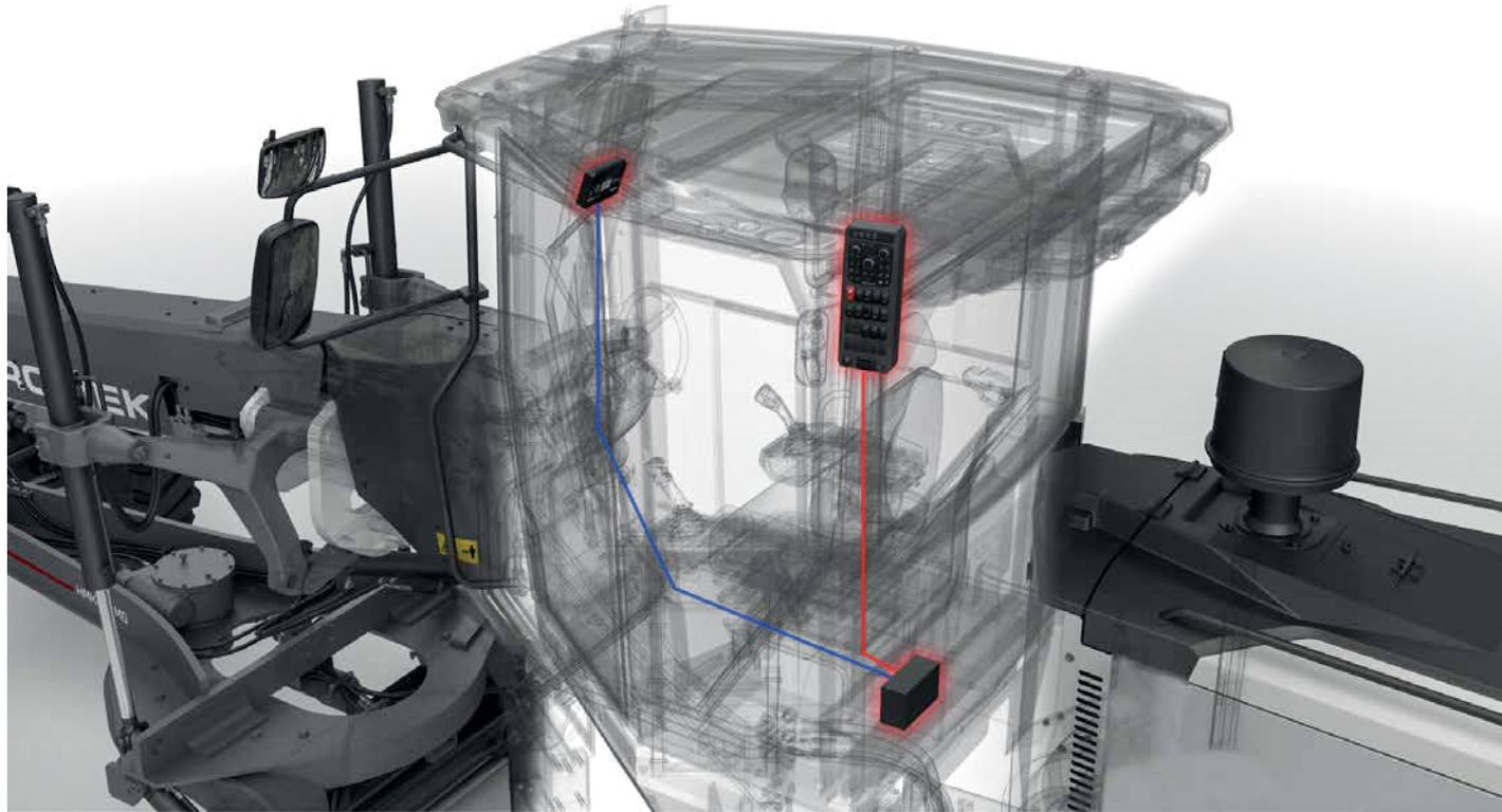
Hidromek Opera est une interface facilitant l'interaction entre l'opérateur et la machine. L'opérateur peut facilement naviguer entre les menus dans Opera, vérifier l'état de la machine et modifier les paramètres.
