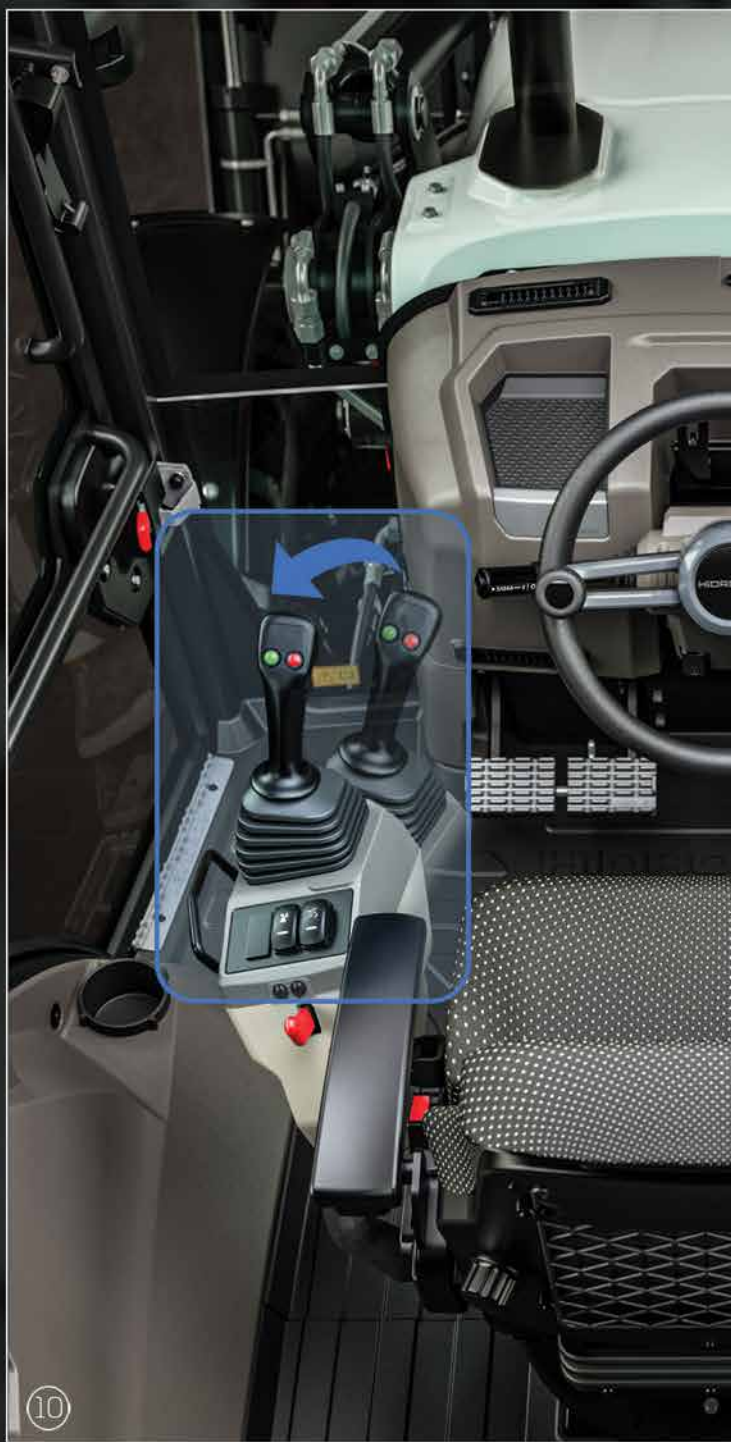
Небольшой наклон левого джойстика более удобен для оператора при работе на стороне погрузчика.
