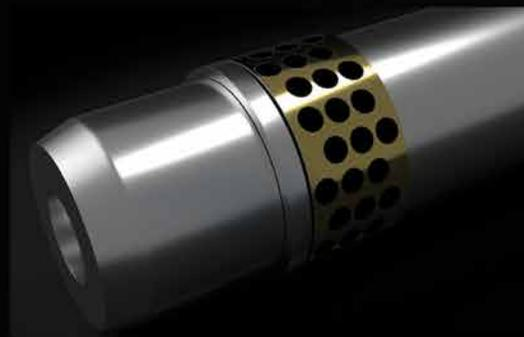
Втулки из бронзы и графита, используемые в местах соединения стрелы/рукояти и стрелы/рамы, увеличивают интервал между смазками и значительно снижают износ пальцев, благодаря графиту, добавленному на внутреннюю поверхность втулок, имеющему высокую абсорбцию смазки и способность ее удержания.
