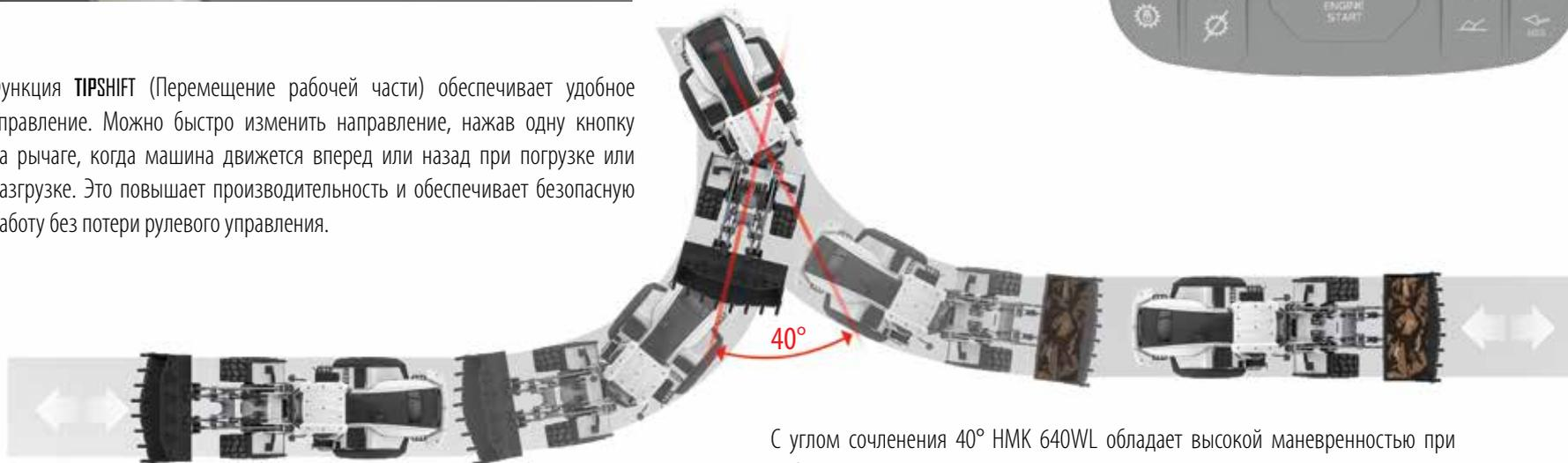
С углом сочленения 40° НМК 640WL обладает высокой маневренностью при работе в узких пространствах в радиусе 7010 мм.
