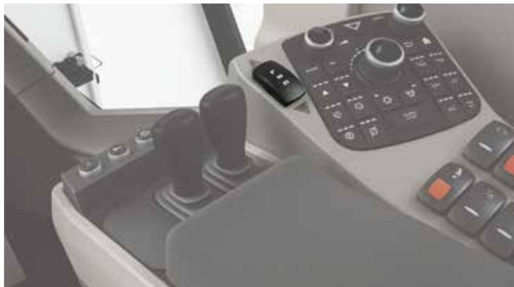
Функция **TIPSHIFT** (Перемещение рабочей части) обеспечивает удобное управление. Можно быстро изменить направление, нажав одну кнопку на рычаге, когда машина движется вперед или назад при погрузке или разгрузке. Это повышает производительность и обеспечивает безопасную работу без потери рулевого управления.
