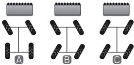
3 diferentes tipos de dirección controlados eléctricamente
