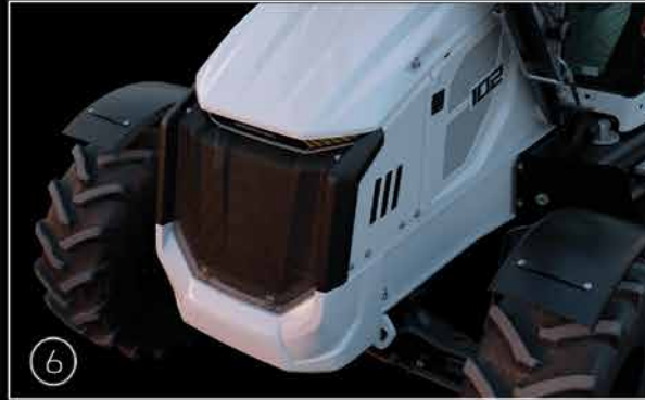
Dayanıklı motor ön ızgarası ve koruma tamponu
